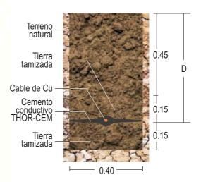
Excave una zanja de 0.40 m de ancho x 0.75 m de fondo como mínimo, tamizar todo el material extraído en una zaranda de 1/2", elimine piedras y hormigón. La longitud de la zanja será determinada por la resistividad eléctrica del terreno y la resistencia eléctrica requerida.
