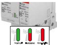
Un sistema de reserva de seguridad para un protección extendida. T1-T2s y T2s. Estos dispositivos de protección contra sobretensiones son equipado con dos varistores por polo. Si un varistor está dañado, el SPD da una advertencia anticipada de que es acercándose al final de su vida mientras el otro varistor sigue protegiendo el equipo, permitiendo realizar mantenimiento preventivo.
